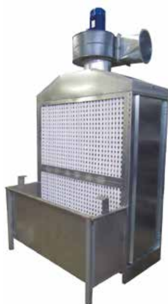
← CS1600-300-Vxx Cabina di aspirazione per il trattamento completo dell'aver-spray distribuzione. Doppio fronte di aspirazione con struttura interna per alloggiamento elementi filtranti cilindrici. Completa sonda di controllo pressione.
