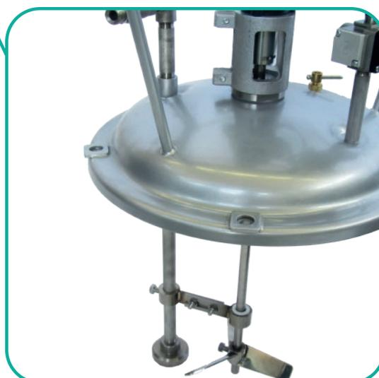
Dettaglio interno tri-pala miscelazione.
